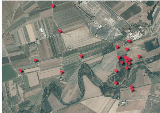
Posizione, nell'area interessata dal progetto, dei piezometri, strumenti che, introdotti verticalmente nel terreno, consentono di misurare la pressione dell'acqua di una falda sotterranea
